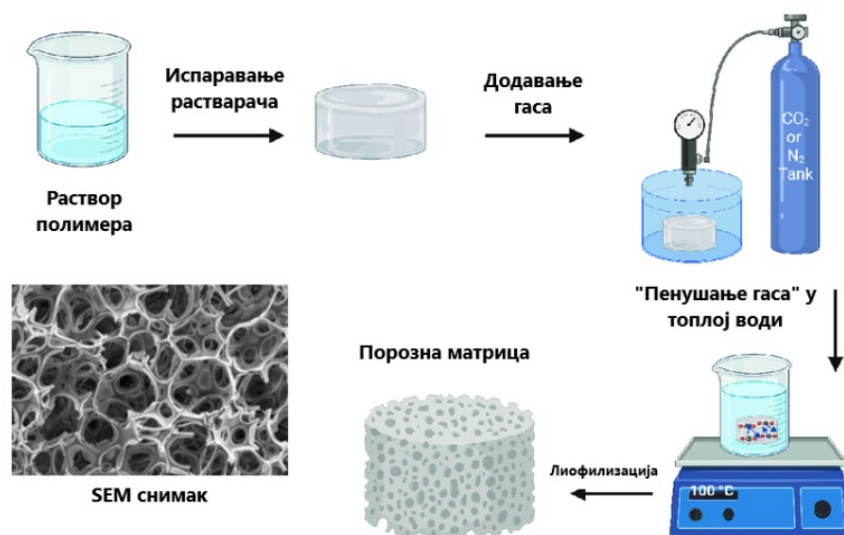
Слика 6. Шематски приказ технике пенушања гаса
